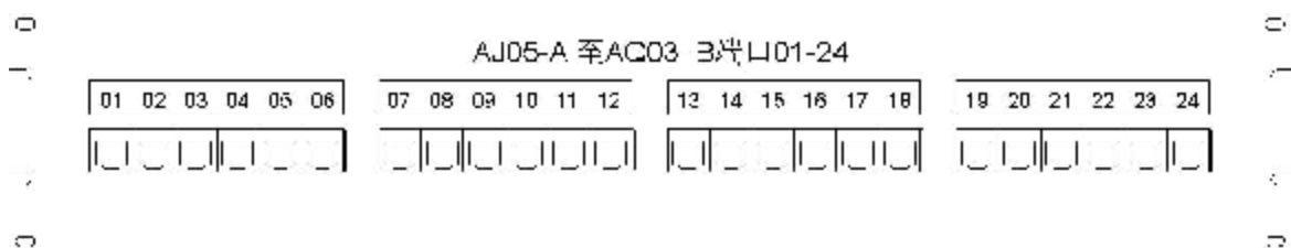
图15 基本8倍密连接插接板面板标识——第二部分
