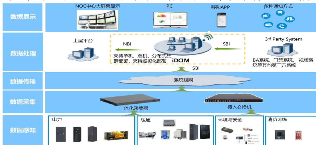
图 1 DCIM 数据中心智能管理系统架构图
