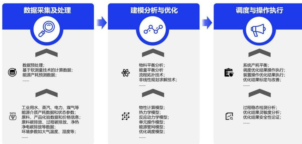
图 5 流程工业能源系统运行调度优化技术原理图
